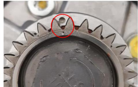
La dificultad está en encontrar las marcas. Las bombas usadas tienen cubiertas parcialmente la rueda dentada con aceite y, simplemente, muchos talleres desconocen las características especiales de esta bomba. Una pegatina en la bomba de inyección indica que deben respetarse las instrucciones especiales de instalación.
